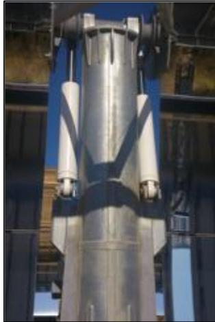
**Figura 19: Drive & Tracker Pylon con Meccanismo di Trazione Tradizionale - Pistoni paralleli**
