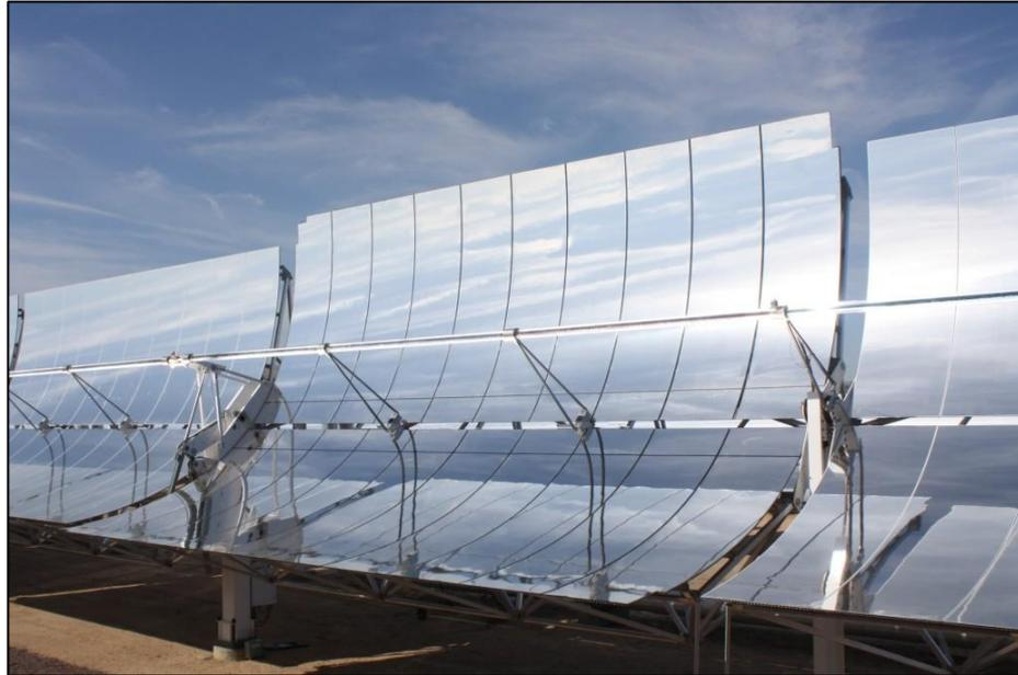
**Figura 18: Collettore parabolico LAT 8.0 m - SCE**
