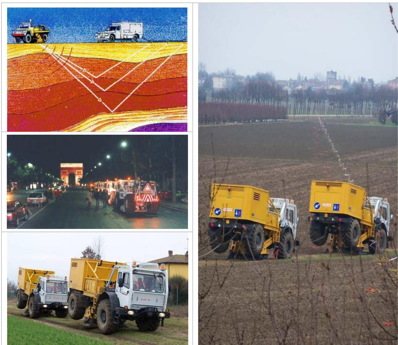
Figura E2 - Energizzazione e propagazione delle onde elastiche; esempio di vibratori su camion.
