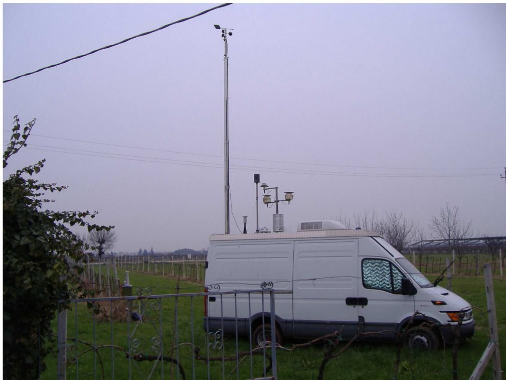
**Fotografia n. 1:** Collocazione del laboratorio mobile e dei campionatori per il PM10 ed il PM2.5.
